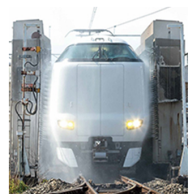
車両基地での車体洗浄
